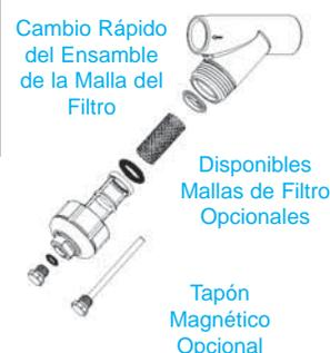
Adecuado para manejo de aire de baja presión hasta 5psi (0.3 kg/cm<sup>2</sup>), no para la distribución de aire comprimido ni gas
